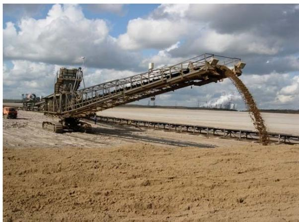
Kleinabsetzer bei der Herstellung von Kipprippen mit Förderband im Hintergrund
