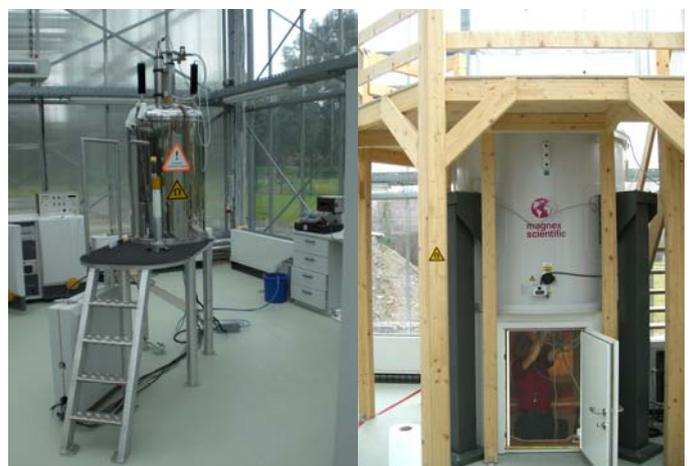
**Abb. 6.1:** 7T und 4.7T „ultra wide bore“ Scanner des EcoNMR Zentrums
