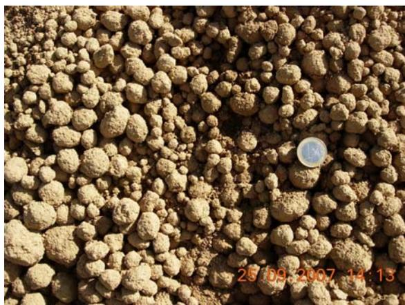
Rollaggregate unterschiedlicher Größe
